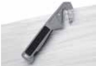
zum Öffnen von folienverschweißten Paletten oder schneiden von Folienbahnen
